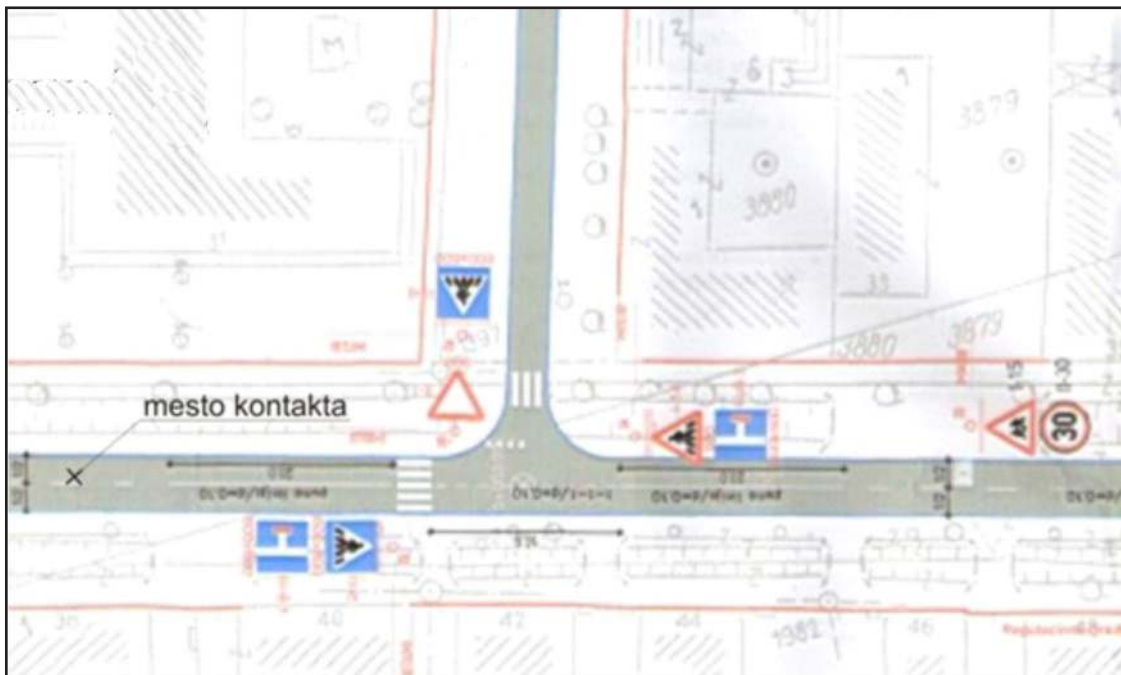
Slika 6. Izvod iz projekta vertikalne saobraćajne signalizacije u zoni mesta nezgode
