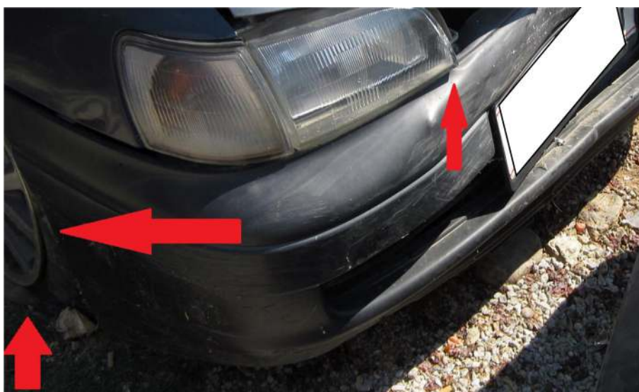
Slika 1. Točak duže vreme van eksploatacije i prednji desni far neoštećen
