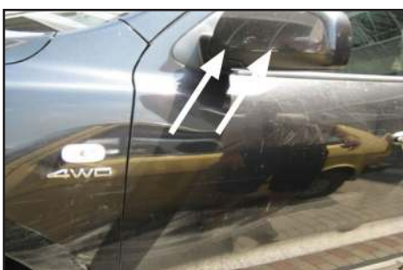
Slika 14. Prikaz oštećenja levog bočnog ogledala [3]
