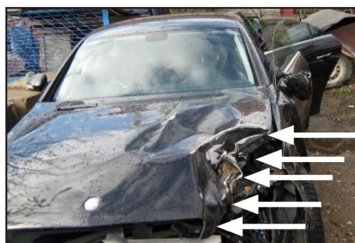
Slika 2. Precizniji prikaz oštećenja poklopca motora [3]
