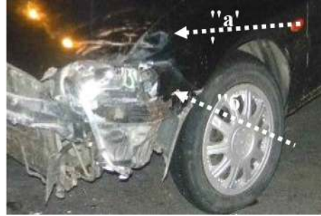
Slika 23. Bliži prikaz oštećenja prednjeg levog blatobrana [3]
