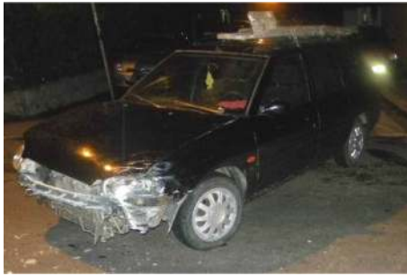
Slika 22. Širi izgled oštećenja prednjeg levog blatobrana [3]
