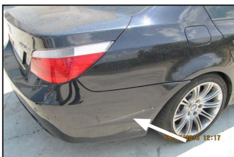
Slika 8. Tragovi grebanja na zadnjem braniku [3]
