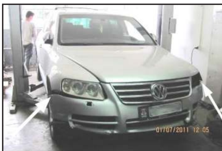
Slika 18. Oštećenje prednjeg branika [3]
