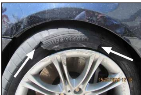
Slika 7. Oštećenja pneumatika- „rascep“ [3]
