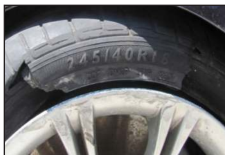
Slika 7. Oštećenja pneumatika- „rascep“ [3]
