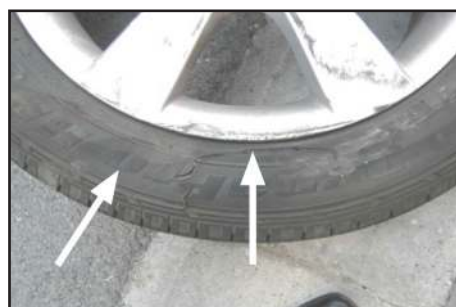
Slika 16. Prikaz oštećenja pneumatika [3]
