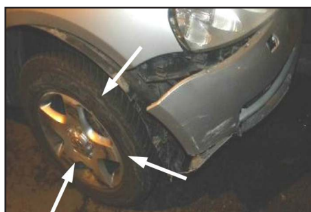
Slika 21. Oštećenje naplatka prednjeg levog točka [3]
