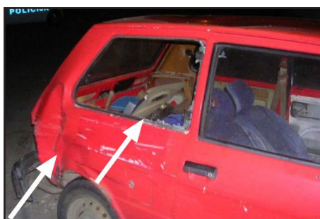
Slika 6. Oštećenje zadnjeg desnog bočnog stakla [3]
