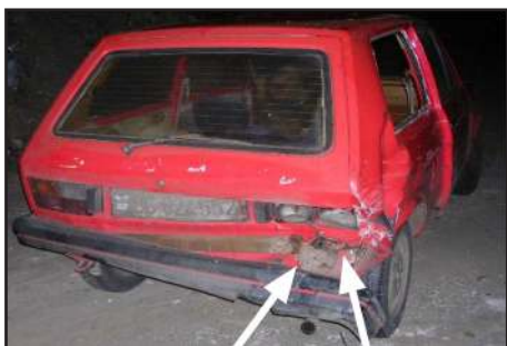
Slika 5. Oštećenja zadnjeg branika [3]
