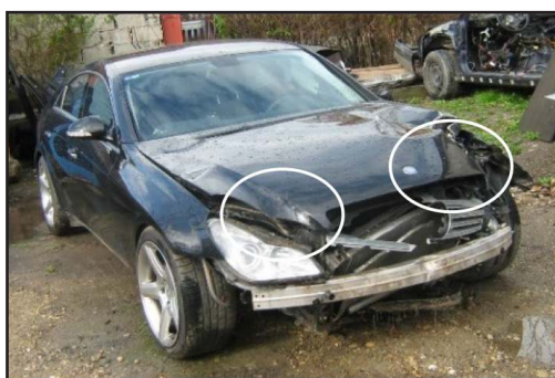
Slika 1. Širi izgled oštećenja poklopca motora [3]
