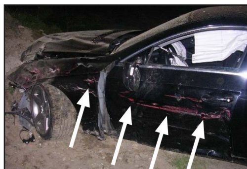
Slika 4. Oštećenja na prednjem levom blatobranu [3]
